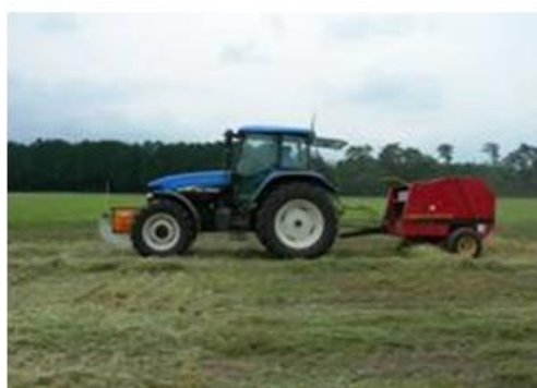
使用切碎捆卷机收割茎叶和打捆成型
